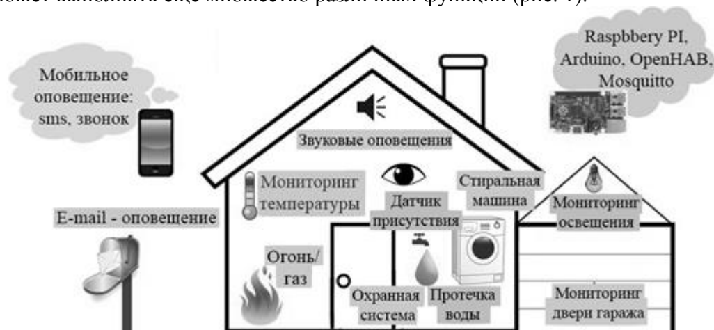
Рис. 1. Наиболее распространённые компоненты системы «Умный дом»
