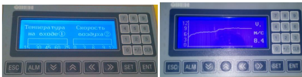
Рисунок 3 – Главный экран панели оператора ИП320 и график изменения скорости потока воздуха
